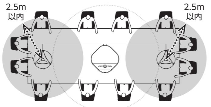
※本製品とUSBスピーカーフォン「USB-SPPHL1」は、できるだけ距離を離して設置してください。
